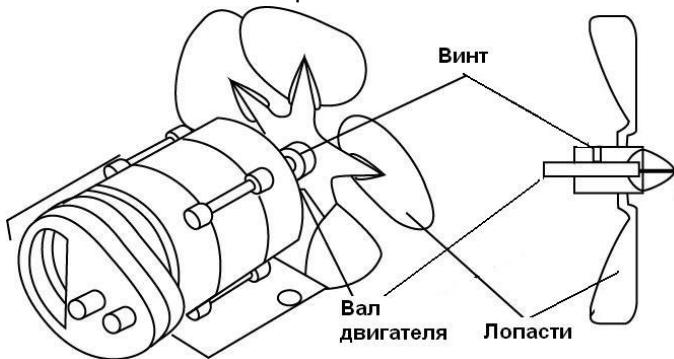
Очищать по мере необходимости, но не реже 1 раза в год. Снимите верхний кожух. Ослабьте винт, удерживающий лопасти на валу и снимите лопасти. Очистите лопасти вентилятора мягкой тканью смоченной в керосине или растворителе. Просушите лопасти и установите обратно на вал. Закрутите плотно винт, установите верхний кожух. При несвоевременной очистке лопастей, появляется дисбаланс вентилятора, что приводит его к выходу из строя.
