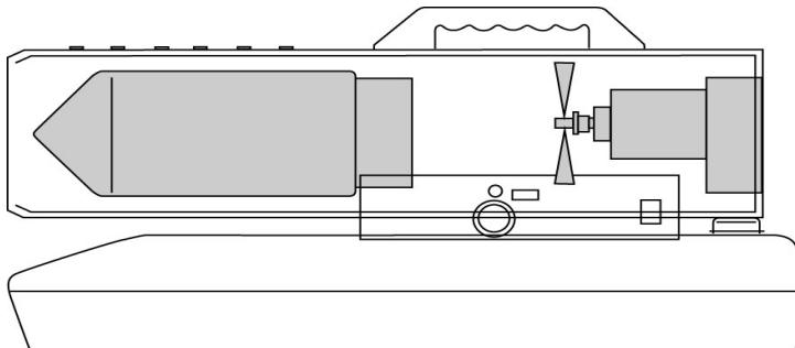
4.2. Нагреватели оснащены системой термозащиты, которая отключит нагреватель, если температура внутри корпуса превысит допустимое значение.
