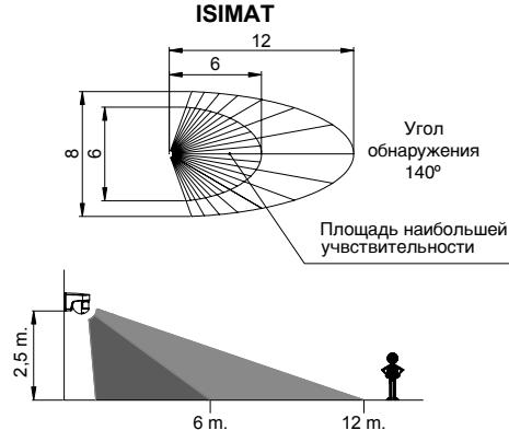
При установке датчика ISIMAT должны принять во внимание, что обнаружение производится пересечением (кроссированием) лучей обнаружения и поэтому, если объект будет двигаться параллельно по отношению к лучам, то будет засечен на более близком расстоянии, так как он не пересекает лучи.
