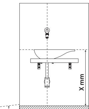
Markieren Sie mit einem Bleistift und mithilfe der Wasserwaage die gewünschte Höhe X des Handwaschbeckens. (Empfohlener Wert: X = 900 mm)
