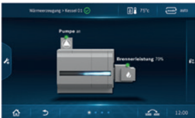
Monitoraggio e regolazione manuale della caldaia
