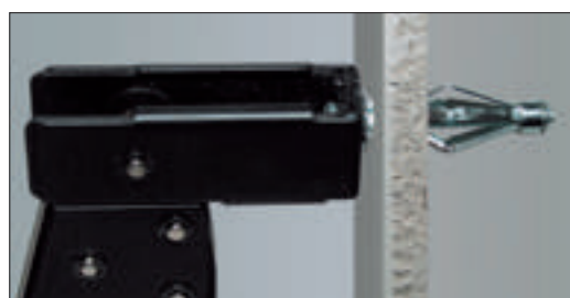
3. Svitare leggermente la vite, per una porzione sufficiente all'inserimento della testa della vite nello speciale utensile (serie HQ); quindi azionare l'utensile a pistola, fino ad ottenere l'apertura a “stella” dell' ancorante.
