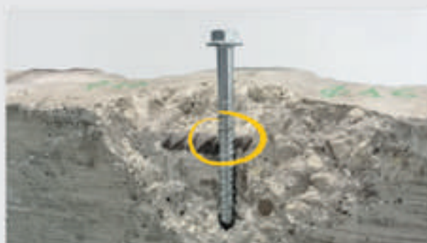
Dettaglio della vite CONCRETO® installata (Calcestruzzo sezionato dopo l'installazione)
