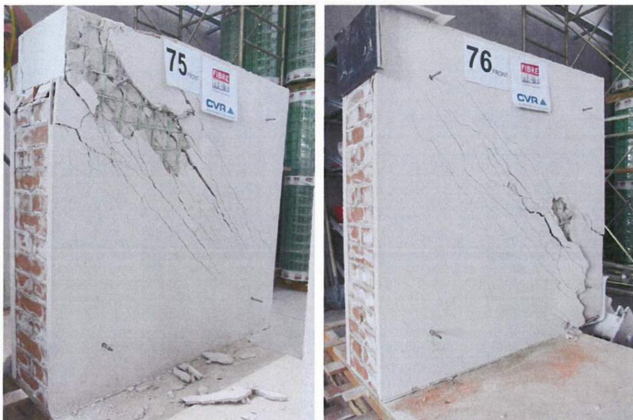
Figura 6: quadro fessurativo a fine prova del campione 75 (sx.) e del campione 76 (dx.)
