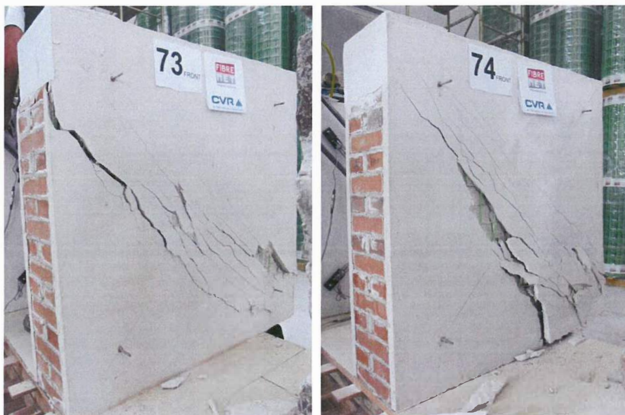
Figura 6: quadro fessurativo a fine prova del campione 73 (sx.) e del campione 74 (dx.)
