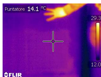
Fig.4 Immagine termografica del campione con Nanocap Fondo rivestito con Nanocap Rasatura dopo 1 ora dall'installazione
