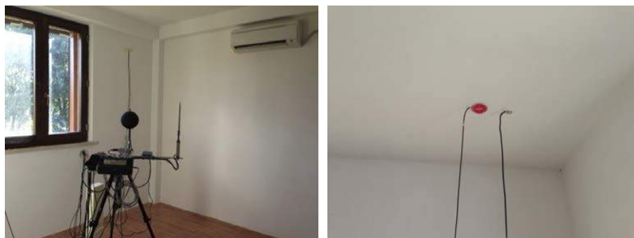
Fig. 13. Stazione microclimatica interna e sensoristica presente all'interno dell'edificio prototipo
